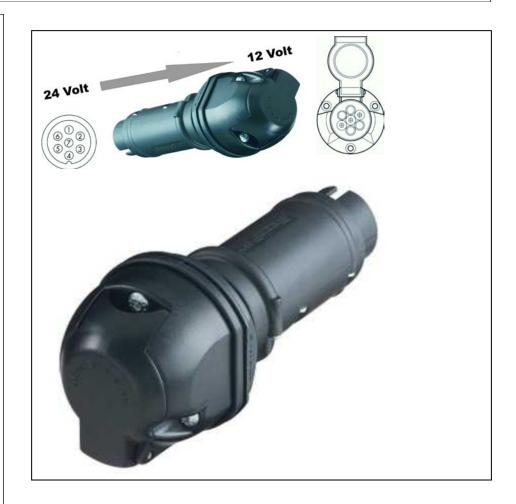
Spannungsreduzierer zur Beleuchtungsversorgung von 12 V Anhänger aus einem 24 V Bordnetz. Elektronik in einem Kurzadapter von 7 polig auf 7 polig ohne Rückfahrleuchte verbaut.
